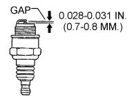
Figure 20. Spark Plug Gap
