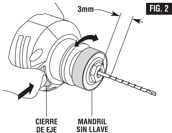
**Nota:** Cuando utilice brocas de 1/4 y 5/32 de pulgada, puede que se necesite usar una llave en la parte delantera del mandril sin llave para apretar firmemente la broca.
